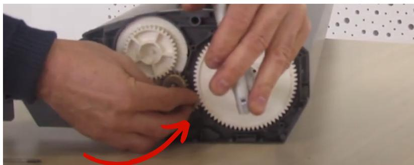
12- Positionnez le cache engrenage, visser les vis pour le maintenir correctement en place et éviter que la tension saute suite à une manipulation. L'étape 1 est finie et toutes les pièces nécessaires ont été enlevé côté engrenage.
